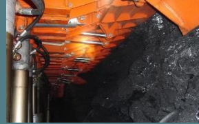
Yarı-mekanize tahkimat uygulaması
